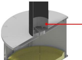
In questo punto, come già menzionato sopra, i fori hanno un diametro di 3,6 mm. Qui è possibile avitare dall'interno le viti autofilettanti fino al serraggio del condotto. Per raggiungere questo punto occorre prima smontare il deflettore.
