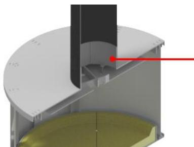
Pour ce faire, il existe comme déjà mentionné, des orifices d'un diamètre de 3,6 mm. Là, les vis à tôle peuvent être serrées depuis l'intérieur jusqu'à ce que le conduit soit bloqué. Pour atteindre cet endroit, il est nécessaire de démonter d'abord le déflecteur.
