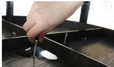
Om de montage en demontage te vereenvoudigen, moeten de schroeven van tevoren in de basiseenheid worden geschroefd.
