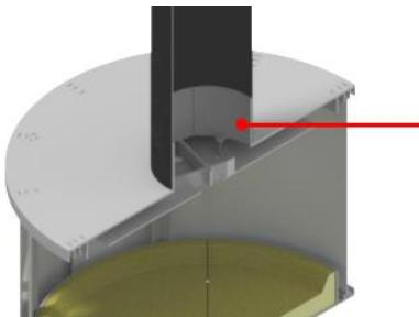
Op dit punt heeft deze, zoals reeds gezegd, gaten met een diameter van 3,6 mm. De plaatschroeven kunnen van binnenuit worden ingedraaid tot de buis is vastgeklemd. Deze plek is alleen bereikbaar als de deflectorplaat niet gemonteerd is.
