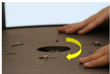
Daarna kan de plaat erop worden geplaatst, zodat de schroeven door de gaten steken. Draai vervolgens de plaat en draai de schroeven aan.
