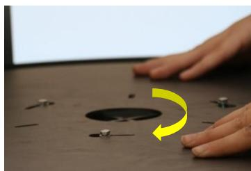
Ensuite, le déflecteur peut être posé sur le dessus de telle sorte que les vis soient en regard des trous. Ensuite tourner le déflecteur et serrer les vis.
