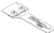
Za enostavno odpiranje in zapiranje stekel med uporabo SURPRISE smo razvili hladno roko. Ta ima na sprednji strani ploščo z zarezo, s katero lahko premikate stekla. Ko je ne uporabljate, jo lahko z magneti pritrdirite spodaj na osnovno telo. Izdelana je iz nerjavečega jekla in je odporna na vremenske vplive.
