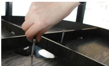
Per semplificare il montaggio e lo smontaggio, occorre prima avvitare le viti al corpo centrale senza serrarle completamente.
