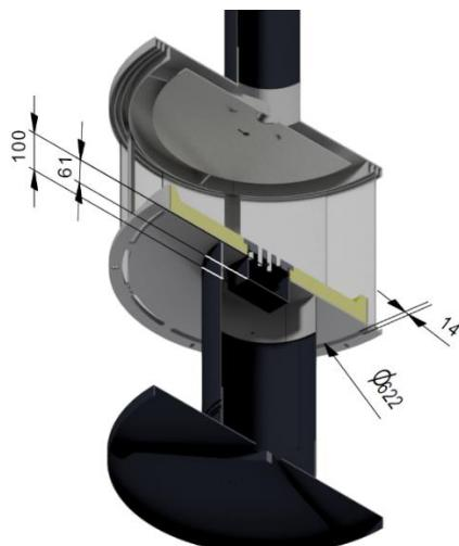
Das Mass von 100 mm ist die Höhe vom Unterboden bis zum dort angeschweissten Ring.
