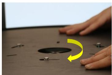
Danach kann die Platte daraufgelegt werden, so dass die Schrauben durch die Löcher schauen. Danach die Platte drehen und die Schrauben anziehen.
