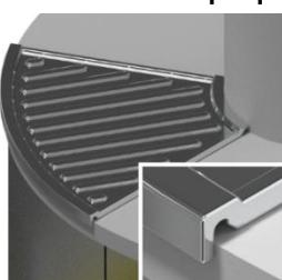
Les plaques de gril en acier inoxydable ou en vitrocéramique, disponibles en accessoires, peuvent être posées à tout moment sur le gril. Elles ne sont pas fixées. Elles sont posées sur la plaque de recouvrement et poussées jusqu'au bord.
