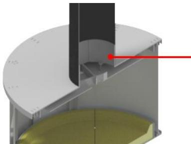
An dieser Stelle hat es, wie bereits erwähnt, Löcher von 3,6 mm Durchmesser. Hier können von innen her Blechschrauben reingedreht werden, bis das Rohr geklemmt wird. Um an diese Stelle zu gelangen muss zuerst die Umlenkplatte ausgebaut werden.
