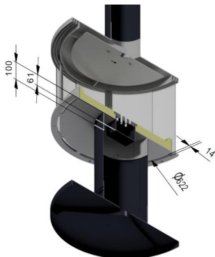
La mesure de 100 mm correspond à la hauteur depuis la structure de base jusqu'à l'anneau qui y est soudé.
