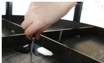
Afin de faciliter le montage et le démontage, les vis doivent être préalablement vissées dans le corps de base.
