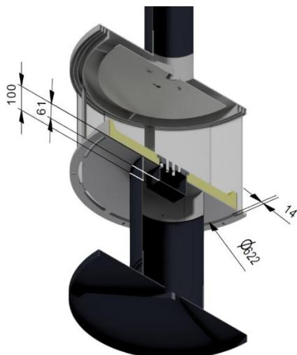
La misura di 100 mm è l'altezza dell'anello saldato al di sotto del corpo centrale.
