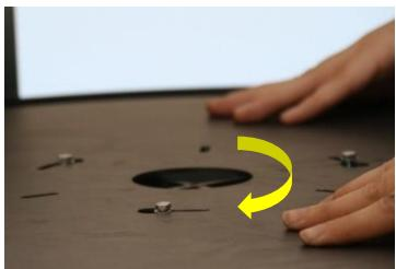
Dopodiché, è possibile posizionarvi sopra il deflettore, in modo che le viti passino attraverso i fori. Quindi ruotare il deflettore e serrare le viti completamente (l'immagine qui a fianco mostra il lato superiore del corpo centrale capovolto per meglio effettuare il montaggio del deflettore).
